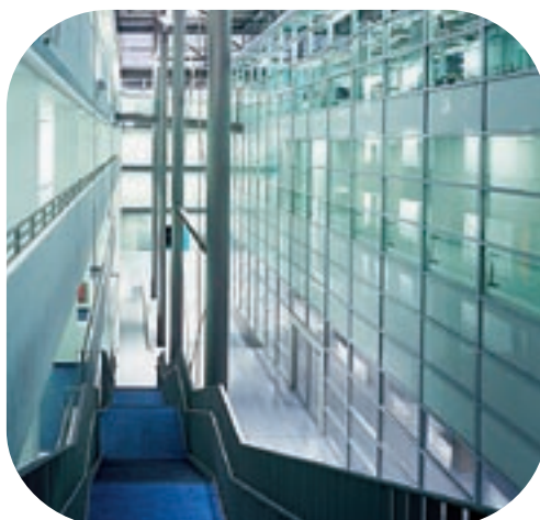
– Картинка слева – Маргаретте-фон-Виттлебен Школа, Берлин: огнестойкая конструкция – низ EI 90, верхняя часть EW 30.
